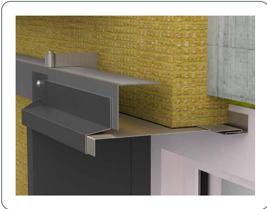
Figur 101 • Installasjon av vindusliste for værskinne
