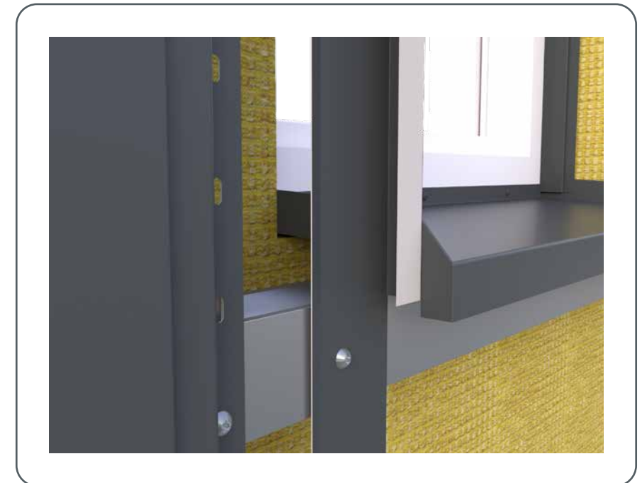
Figur 96 • Montering av braketten i vinduet avsløre
