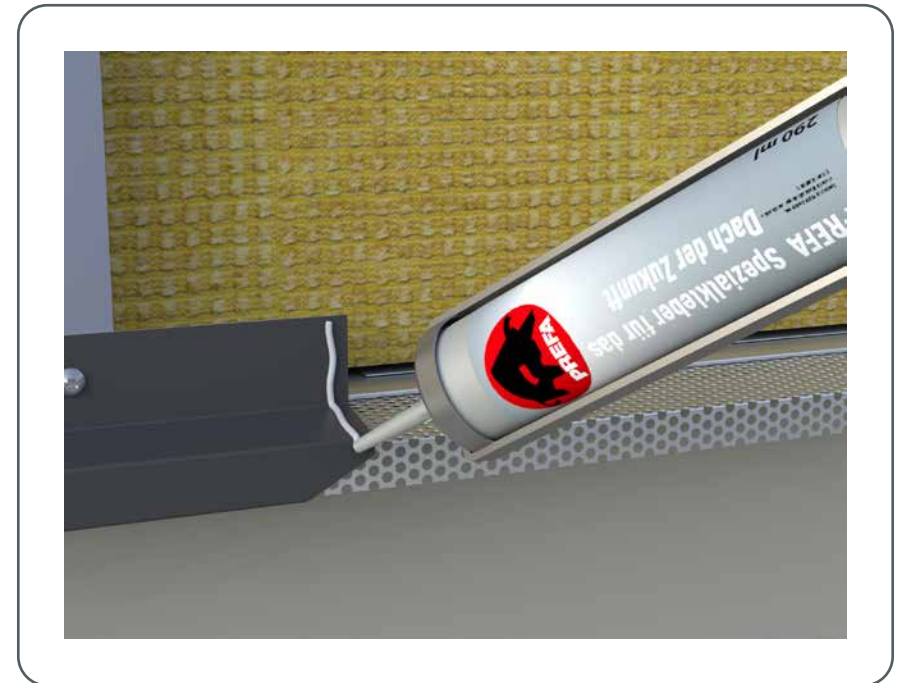
Figur 68 • Støt av værbein
