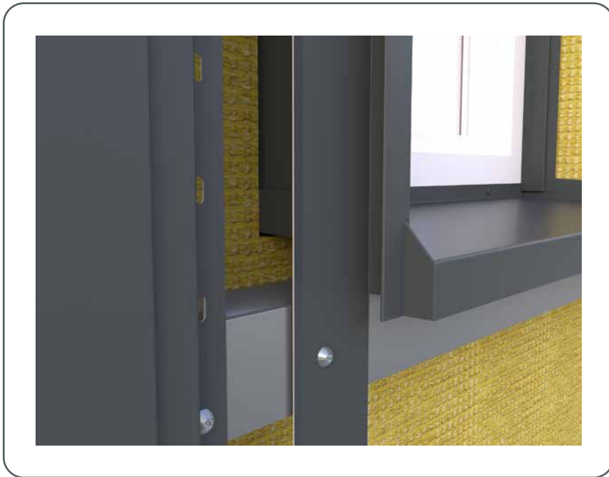
Figur 99 • Installasjon av vindusdeksel
