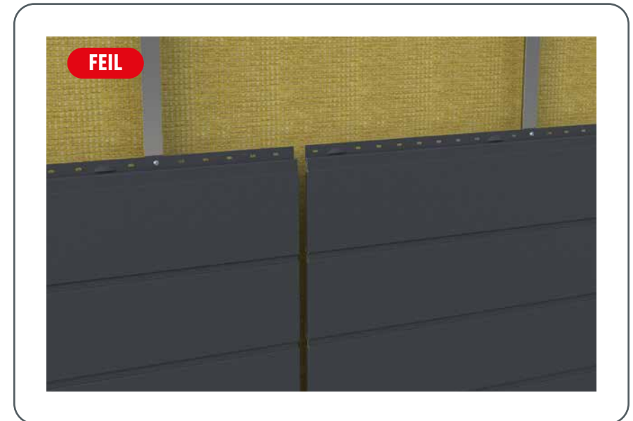
Figur 92 • Åpne rumpeskjøter ikke ok
