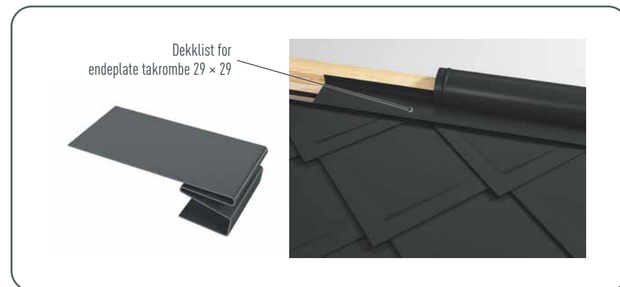
Figur 70 • Dekklister for endeplater | Montering med endeplater
