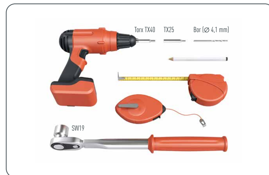
Figur 90 · Snøfanger for rundstokk –nødvendig verktøy
