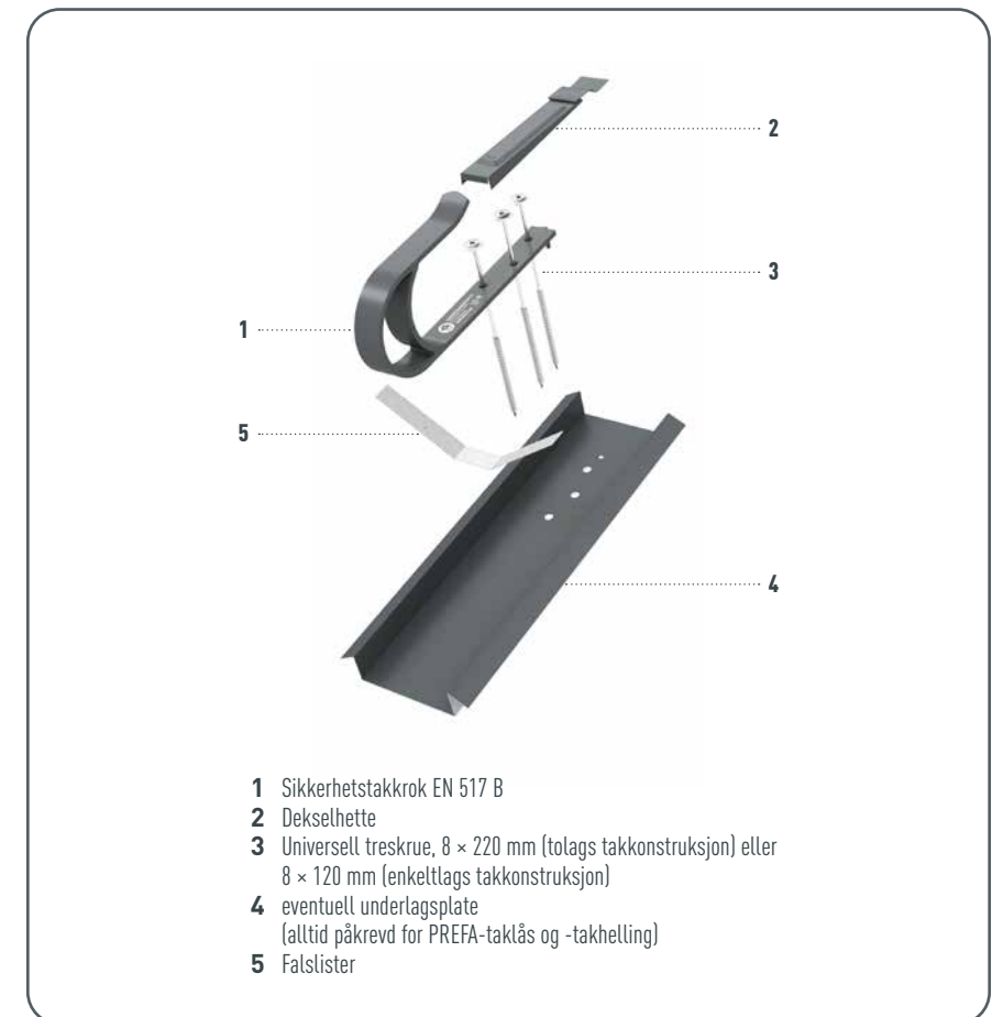
Figur 101 · Sikkerhetstakkrok – nødvendig materiale
