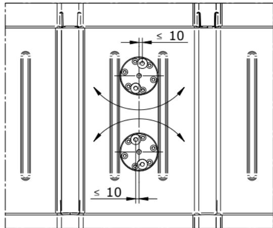
Dersom boringen blokkeres av en skrue i takkonstruksjonen, kan fotdelen dreies maks. 10 mm (se skisse).
