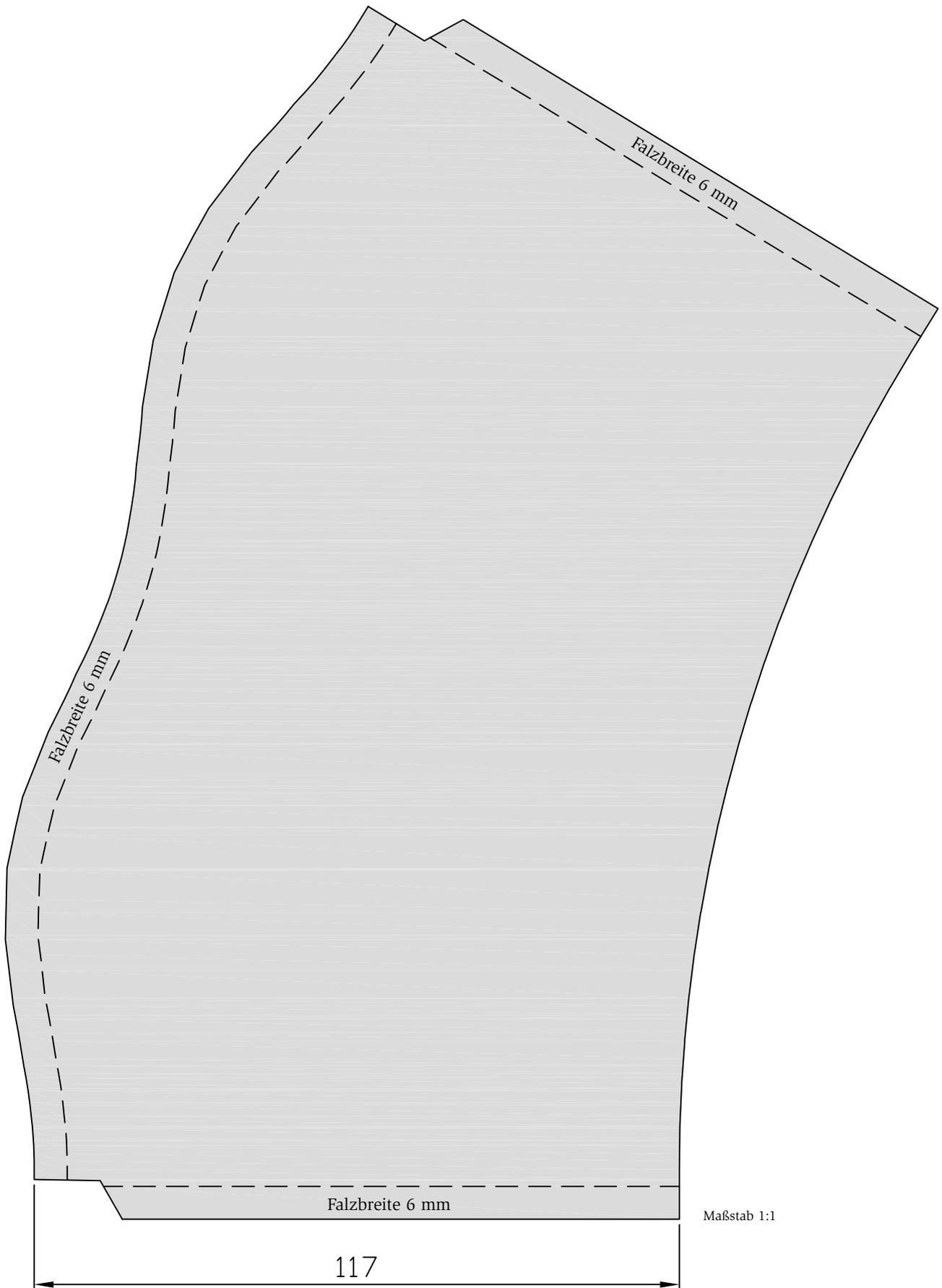
Schablone für die Herstellung des Abdeckrohrs
